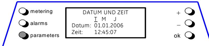
**Datum** Dieser Parameter gestattet die Datumseinstellung der USV-Echtzeituhr. Der eingegebene Wert wird darauf geprüft, dass der im Format "**TT.MM.JJ**" einzugebende Wert reell möglich ist.
