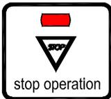
a) Die leuchtende LED bedeutet, dass die *Batterieautonomie* nur noch 3 Minuten beträgt (einstellbar).
